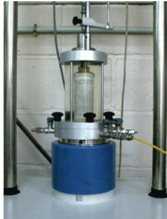
FIGURA 57. Instrumentación empleada para la realización de un ensayo triaxial de suelos. De este ensayo se extraen propiedades del terreno tales como el ángulo de rozamiento interno o la cohesión
