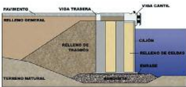
FIGURA 27. Tipología muelle de cajones
