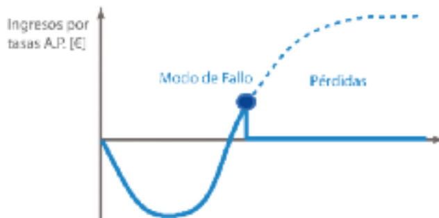
FIGURA 104. Flujo de caja (Cash-flow) de un proyecto. En la fase de construcción será negativo, debido a que se ha realizado una inversión. En la fase de explotación debe ser positivo, debido a que percibe ingresos por la actividad que sustenta la obra. Sin embargo, al producirse un modo de fallo (MF), se registran pérdidas debido a que estos ingresos dejan de producirse
