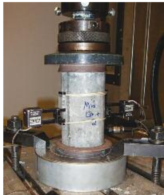
FIGURA 58. Ejemplo de probeta llevada al ELU por compresión simple. De este ensayo se obtienen parámetros tales como Resistencia a compresión, que depende a su vez del número de días de curado de la probeta en el caso del hormigón
