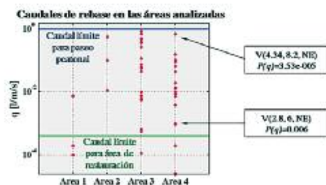
FIGURA 7. Caudales de rebase obtenidos para cada una de las cuatro áreas de estudio con los vectores climáticos definidos a partir de la serie temporal de la Boya Costera. En las áreas 1 y 4 se supera el caudal máximo admisible para explotar las instalaciones de restauración que se construyeron en las mismas
