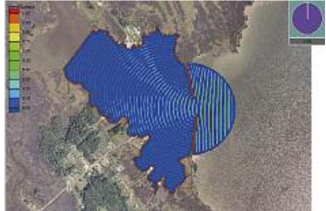
FIGURA 15. Simulación de propagación de oleaje en Tedious Creek, Maryland, mediante el modelo CGWAVE, que resuelve la ecuación de pendiente suave (Coastal & Hydraulics Laboratory, US Army Corps of Engineers)
