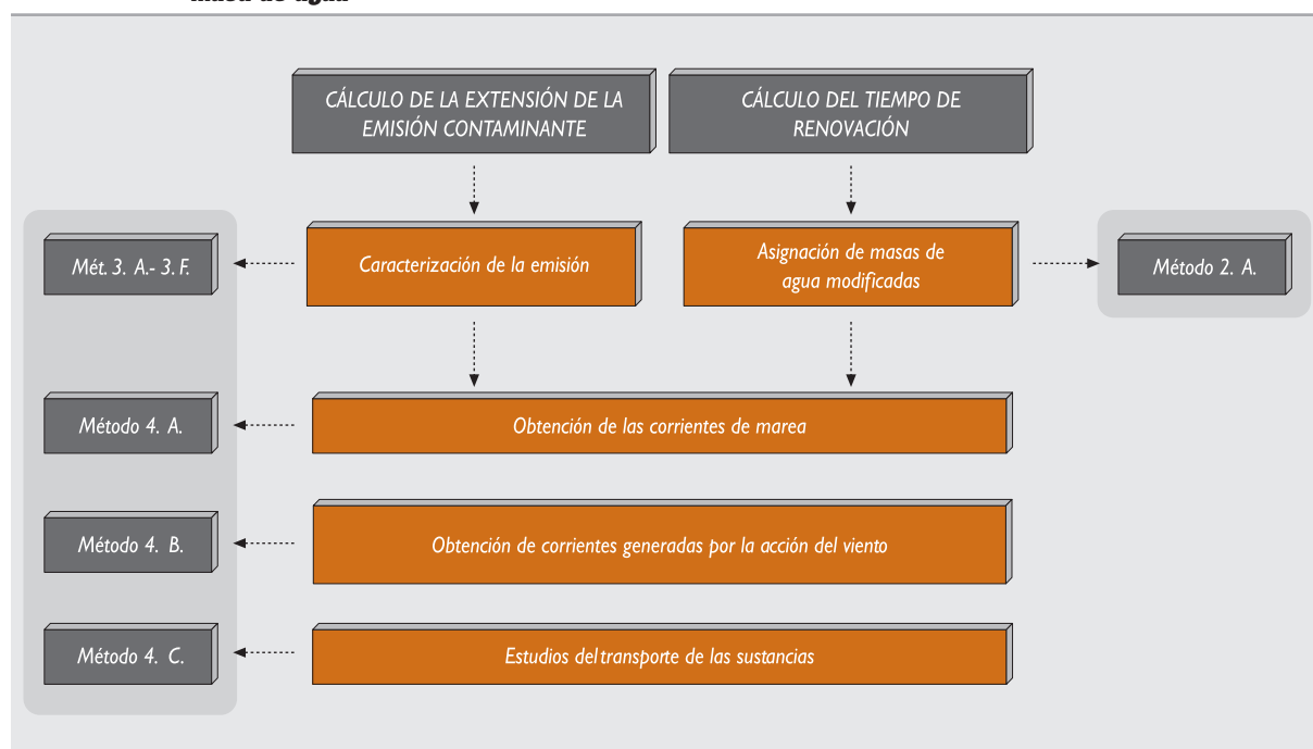
Figura 4.1.III. Métodos de cálculo de la extensión de la emisión contaminante y del tiempo de renovación de la masa de agua
